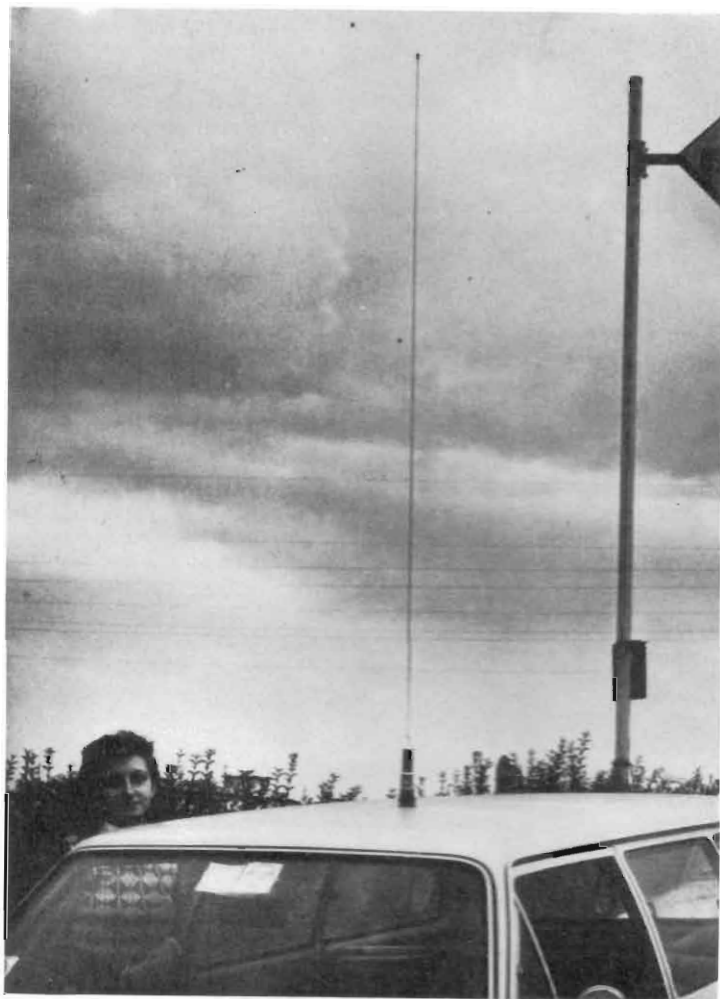
Due tipici esempi di ancoraggio centrale a tettuccio; l'unico svantaggio è quello di dover bucare la carrozzeria in un punto troppo visibile.
