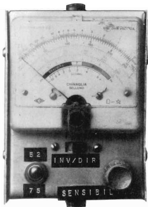
Pannello da sostituire sul milliamperometro
